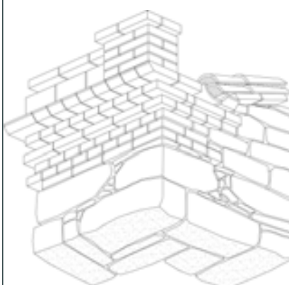
A3_ B Coronamento di testata con fila di tegole sovrapposte a un ricorso di tavelle.
